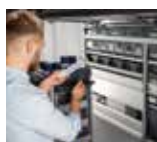
otočené zásuvky umožňují ergonomickou obsluhu vně vozidla
