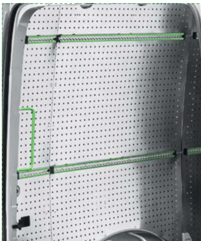
Obložení vnitřních stěn s modulárním systémem napojení na stěny (rail / prorail)
